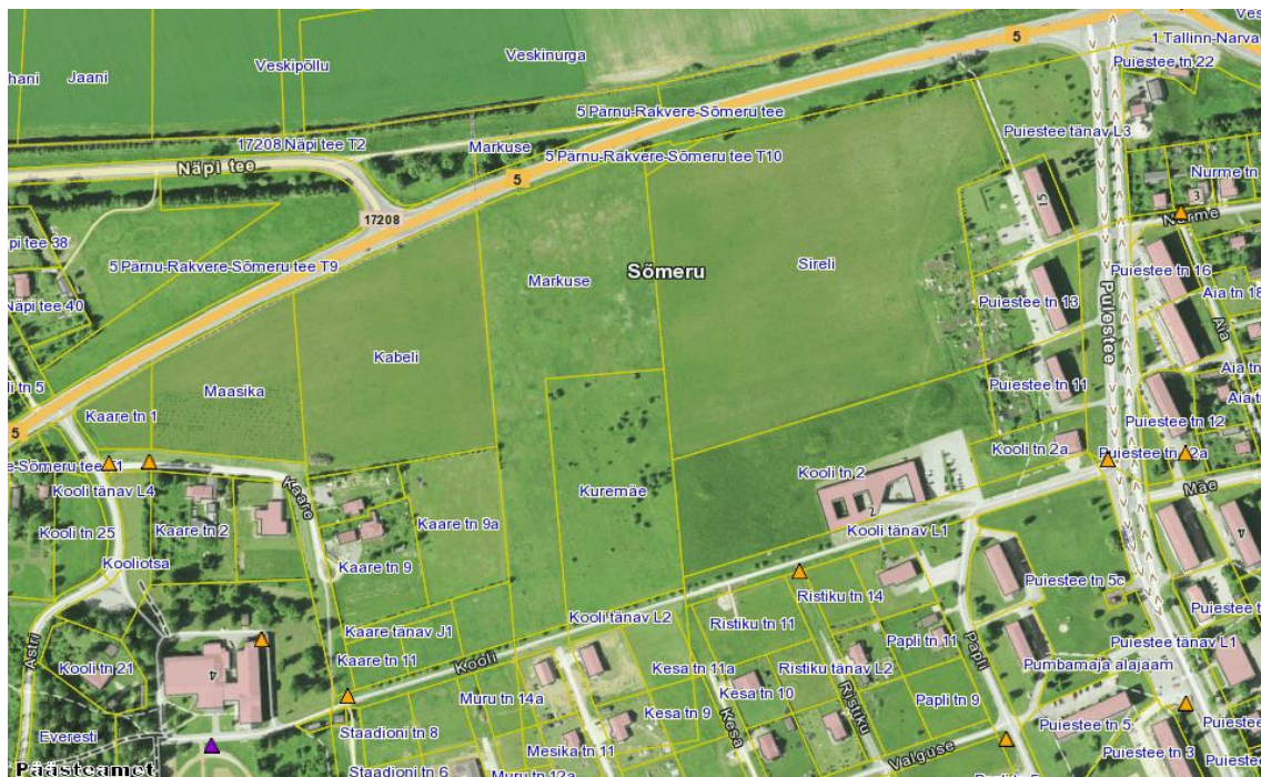
Joonis 2. Tuletõrje veevarustuse asukohaskeem. Kollasega märgitud olemasolevad hüdrandid ning lillaga olemasolevad tuletõrje veevõtukohad. (Allikas: Maa-Amet)
