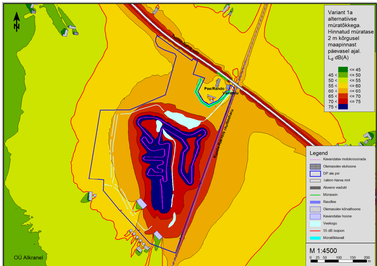
Joonis 3.2. Motokrossiraja igapäevase olukorra (variant 1a) müraleviku kaart päevase aja kohta, kui rakendatud on leevendav meede (müratõke).
